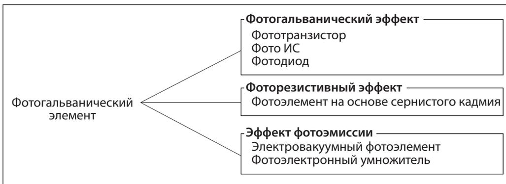
*Фотоэлектрический эффект и оптические датчики.*
