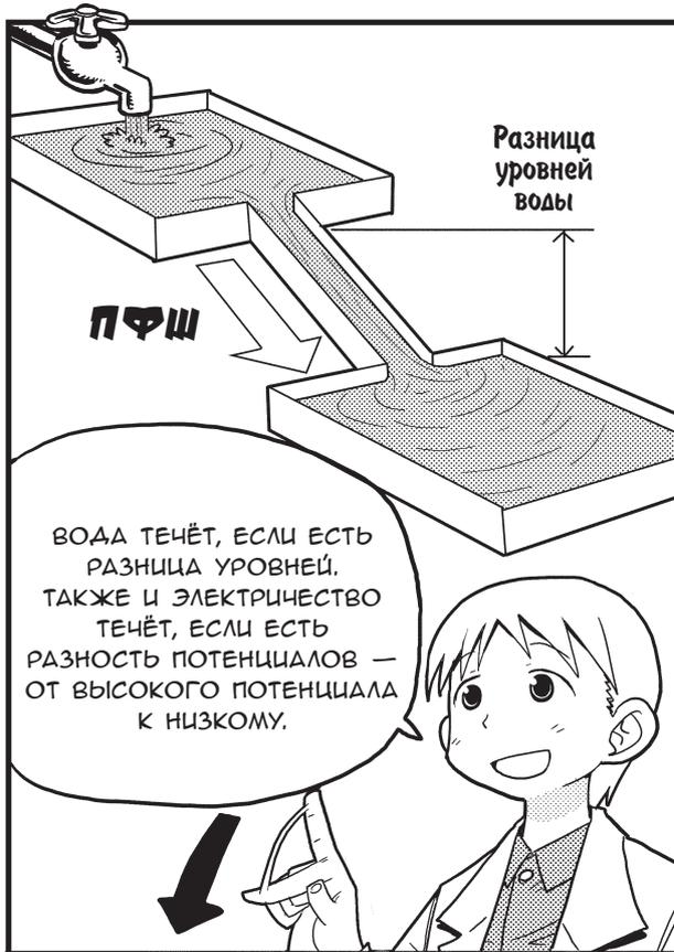
НАПРЯЖЕНИЕ — ЭТО РАЗНОСТЬ ПОТЕНЦИАЛОВ МЕЖДУ ДВУМЯ ТОЧКАМИ. ПОЭТОМУ У НИХ ОДНА ЕДИНИЦА ИЗМЕРЕНИЯ.
